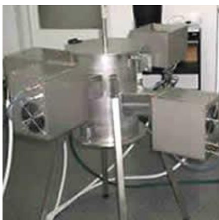
Ryc. nr 1. Reaktor ATON 200 przeznaczony do utylizacji niewielkich ilości odpadów szczególnie niebezpiecznych
